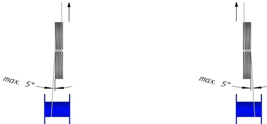
Pour les câbles creux soumis à d'importantes forces de traction lors de leur pose, les gorges du tambour de frein doivent être adaptées au diamètre des câbles. Ceci permet d'éviter toute déformation permanente des câbles creux dans la zone d'enroulement des câbles autour du tambour de frein.
