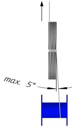
Bei Hohlseilen sind in Verbindung mit hohen Verlegezugspannungen die Bremstrommelrillen dem Seildurchmesser anzupassen. Dadurch soll verhindert werden, dass das Hohlseil im Bereich der Bremstrommelumschlingung bleibend verformt wird.
