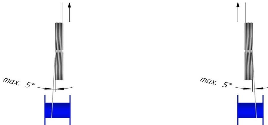
Pour les câbles creux soumis à d'importantes forces de traction lors de leur pose, les gorges du tambour de frein doivent être adaptées au diamètre des câbles. Ceci permet d'éviter toute déformation permanente des câbles creux dans la zone d'enroulage des câbles autour du tambour de frein.
